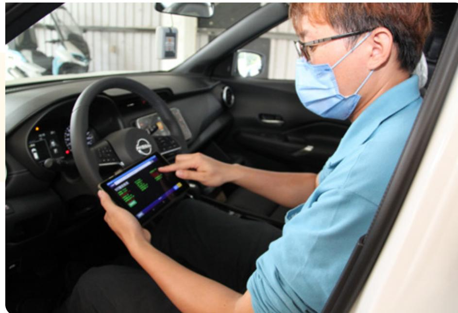
▲ 動態道路測試監控系統
